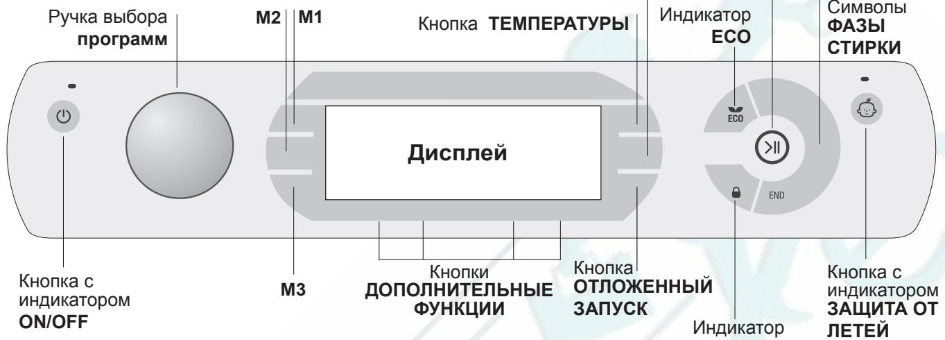
**Кнопка с индикатором ON/OFF:** нажмите кнопку один раз для включения или выключения машины. Зеленый индикатор показывает, что машина включена. Для выключения стиральной машины в процессе стирки необходимо держать нажатой кнопку, примерно 3 секунды. Короткое или случайное нажатие не приведет к отключению машины. В случае выключения машины в процессе стирки текущий цикл отменяется.
