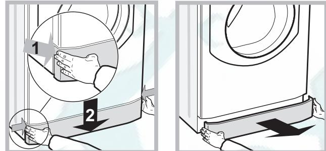
1. снимите переднюю панель стиральной машины, нажав в центре, затем потяните ее вниз за края и снимите ее (см. схемы).
